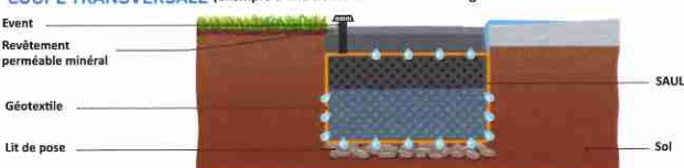
COUPE TRANSVERSALE (exemple d'une tranchée d'infiltration en grave en SAUL* avec alimentation diffuse)
