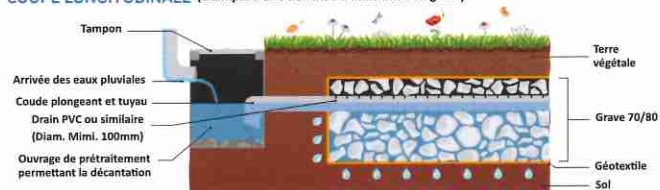
COUPE TRANSVERSALE (exemple d'une tranchée d'infiltration en grave en SAUL* avec alimentation diffuse)
